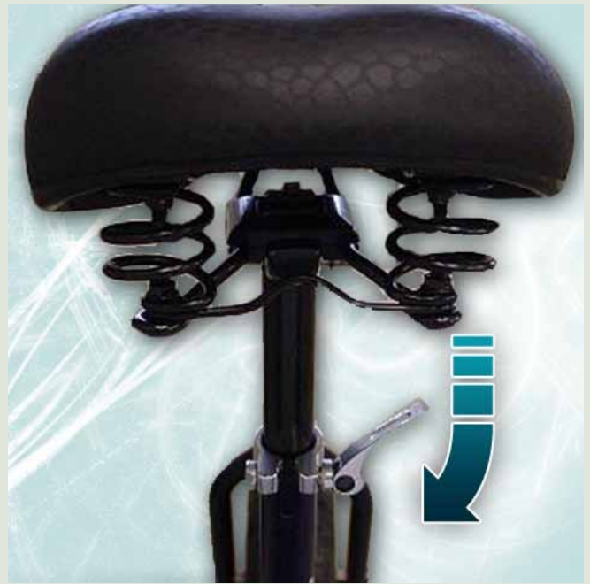
Foto 4: het vastmaken van de snelspanner
