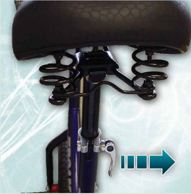
Foto 3: het losmaken van de snelspanner
