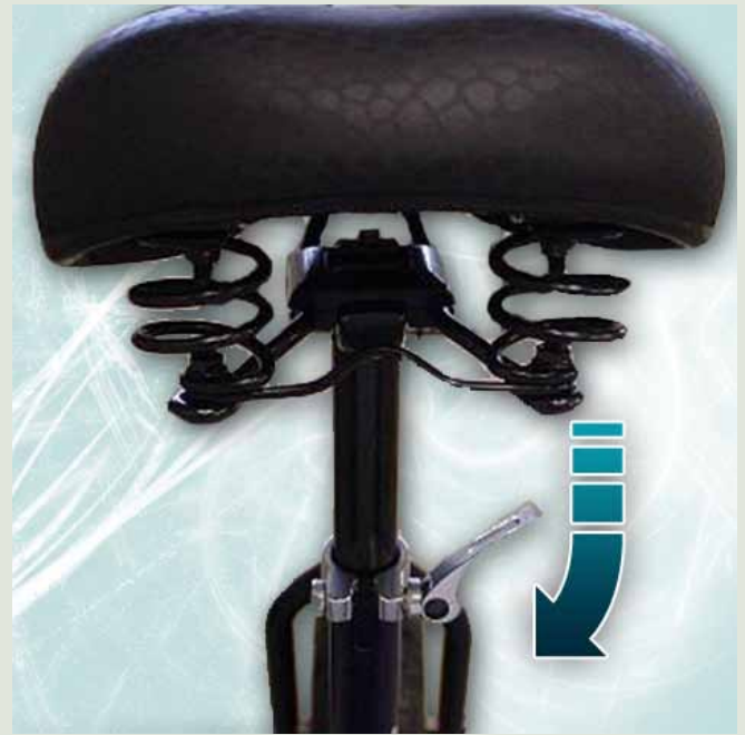
Foto 4: het vastmaken van de snelspanner
