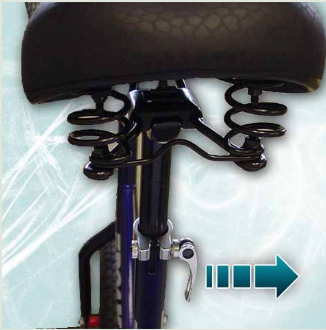
Foto 3: het losmaken van de snelspanner
