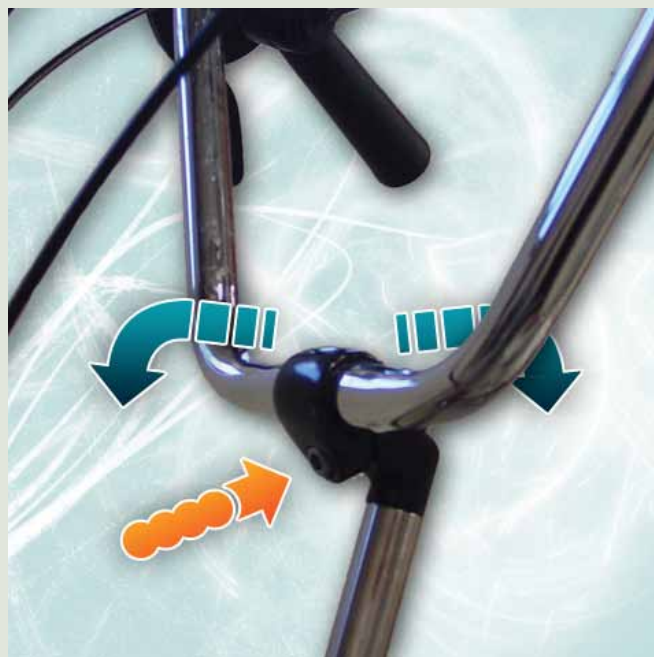
Foto 1: door de inbusbout los te draaien kan het stuur worden gekanteld.
