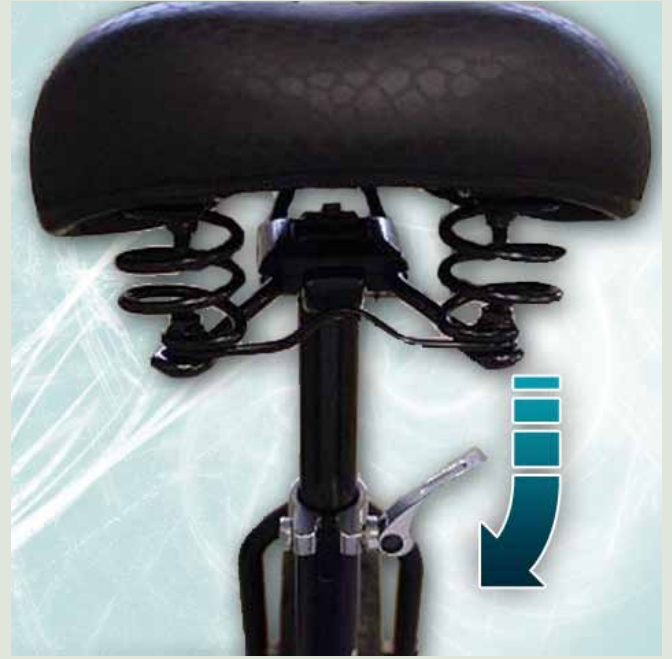
Foto 4: het vastmaken van de snelspanner
