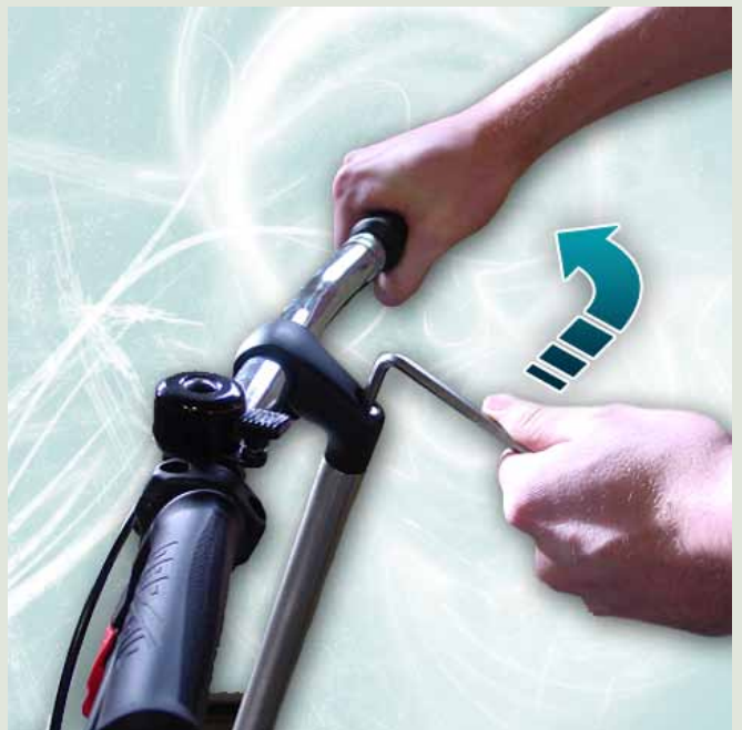
Foto 6: de expanderbout losdraaien
