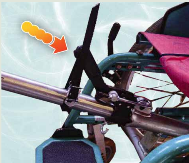
Foto 1: de hendel met borging door de veiligheidsriem
