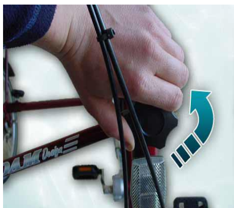
Foto 2: draai de sterknoppen los en haal het kruisframe weg.
