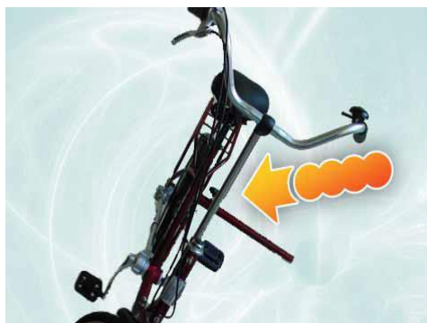
Foto 4: Draai de laatste sterkknop los ok de koker te kunnen verwijderen.
