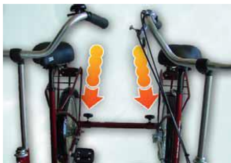
Foto 3: Middels een koker en twee sterknoppen worden de fietsen met elkaar verbonden.
